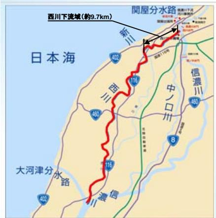
西川は、大河津分水路から分かれて蒲原平野の西側を貫いて流れ、新潟市内で再び信濃川に合流する、長さ44.5kmの一級河川である。流域は、弥彦山や角田山が連なる山系と海岸に沿って発達した、砂丘の背後に広がる田園地帯となっている。西川下流域は、全般に地盤が低く、更に昭和30年代初めより生じた地盤沈下によって最も激しい地区でT.P.-1.9mまでも下がり、極端な天井川を形成している。
